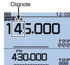
Lorsque la fréquence change par pas de 10 MHz.
