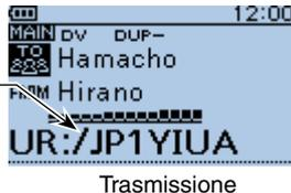
**SUGGERIMENTO:** La chiamata Gateway CQ viene utilizzata per chiamare tutti, ma è possibile chiamare una stazione specifica pronunciando semplicemente il relativo indicativo di chiamata.
