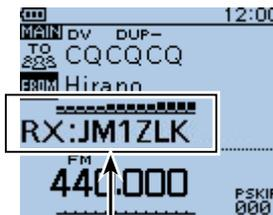
Appare il misuratore S e viene visualizzato l'indicativo di chiamata del chiamante.
