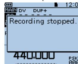
**SUGGERIMENTO:** Se la funzione Registrazione automatica del PTT è impostata su ON nella schermata Menu, la registrazione si avvia automaticamente quando viene premuto [PTT]. (MENU > Voice Memo > QSO Recorder > Recorder Set > PTT Auto REC)
